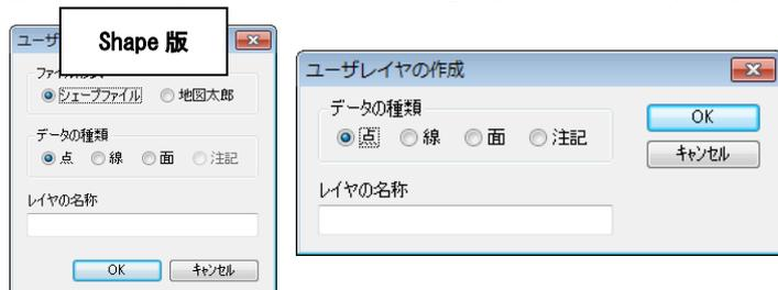
一つのレイヤに異なるデータの種類（点・線・面）を作成することはできません。点のレイヤは点データのみ、線のレイヤは線データのみ、面のレイヤは面データのみを作成します。
