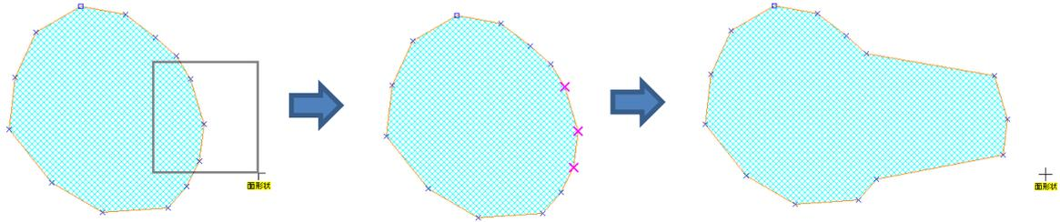
**※接する面の境界上の補間点（同じ座標を持つ）を選んで移動すると2つの面を同時に形状変更します。（重なる補間点を同時に移動します。）**
