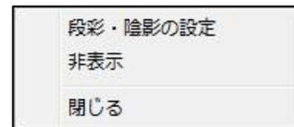
再度凡例を表示させる場合は「表示項目の設定」ダイアログにて標高メッシュレイヤを右クリックし「凡例 (段彩・陰影)」をクリックすると表示されます。
