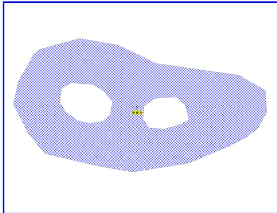
注意 中抜きのある面データを2分割する場合、【面の中抜き・リージョン解除】で中抜きを解除してから行います。
