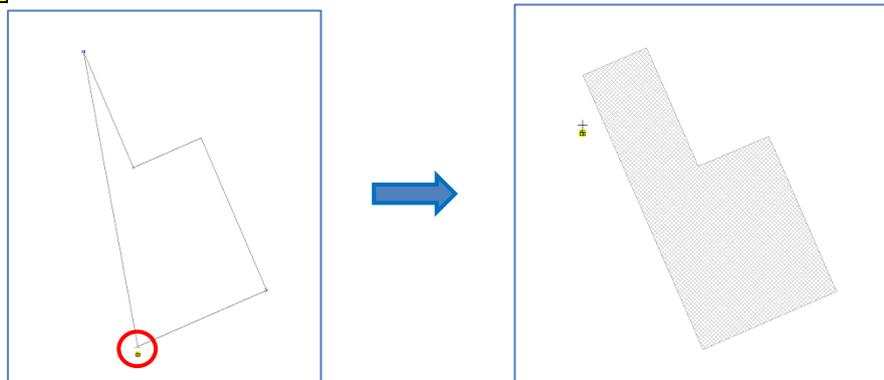
最後の補間点クリック後、右ボタンクリックで自動的に面が構成されます。
