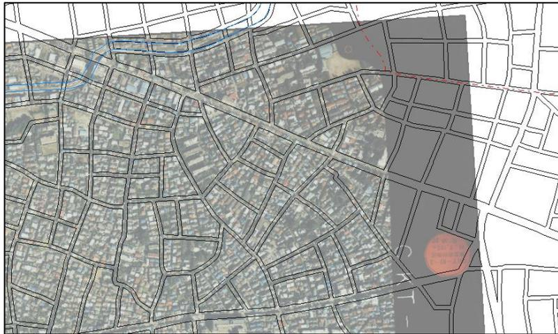
位置合せの微調整(変形)では、四隅のいずれか一箇所を動かすと、先に位置合せを行ったところが他の変形の影響を受けて微妙にずれてしまいます。ある程度重なったところで、画像の全体表示をおこない、全体的なずれを確認し再度調整を繰り返します。全体の位置が概ねあったことを確認します。
